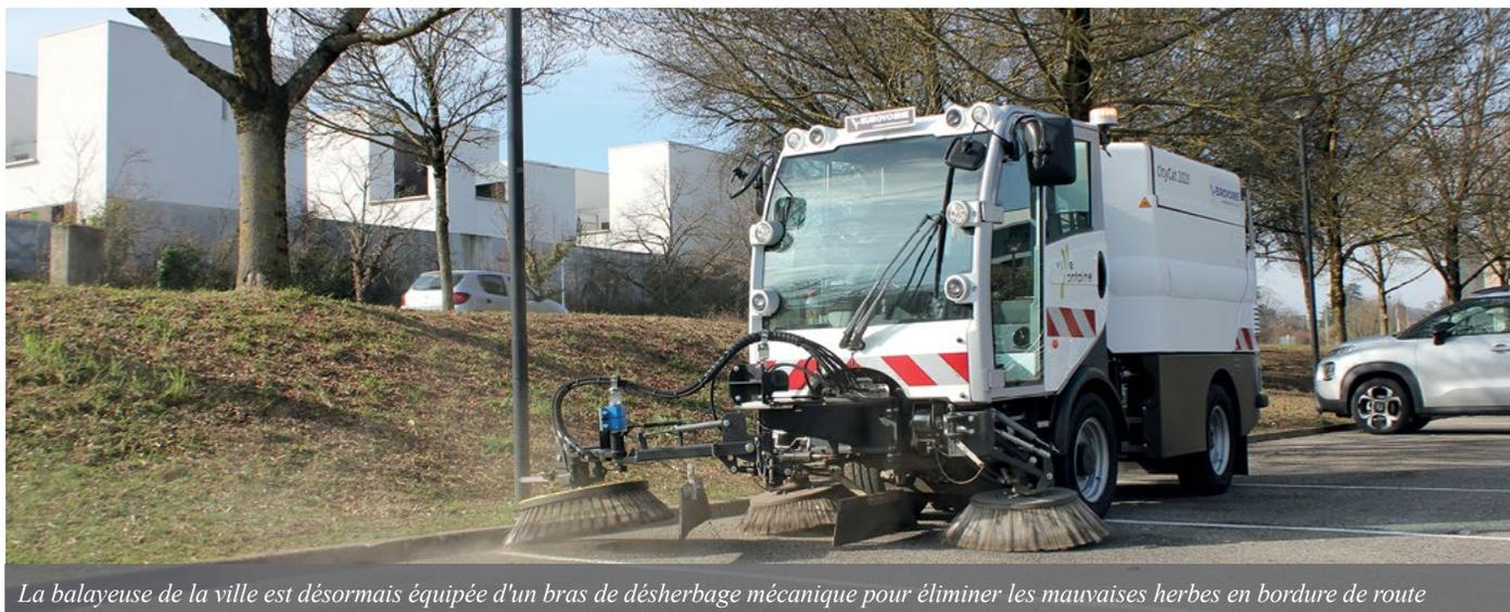
La balayeuse de la ville est désormais équipée d'un bras de désherbage mécanique pour éliminer les mauvaises herbes en bordure de route
