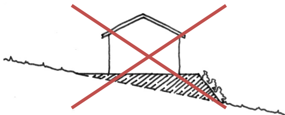
la mise à niveau par talutage
