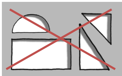
formes de baie « inventive », s'intégrant mal à l'architecture traditionnelle, à proscrire
