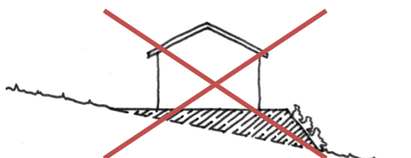
la mise à niveau par talutage
